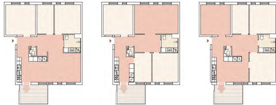
Kuva 14. Ulkotilan sijainti suhteessa muuhun huoneiston tilajärjestykseen on oleellista tilanteessa, jossa sisätilan huonejärjestys on suunniteltu muunneltavaksi, joten tilajärjestys voi muuttua rakennuksen elinkaaren aikana. Käynti ulkotilaan on tällöin luontevaa sijoittaa alueelle, joka säilyy pysyvästi yhteiskäytössä tilajärjestyksestä riippumatta. Kuvassa punainen alue kuvaa yhteiskäyttöistä tilaa ja beige alue makuuhuoneita.
