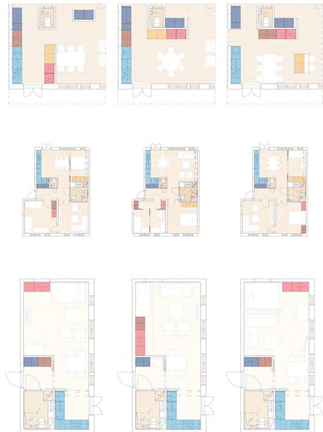
Kuva 98. Käyttäjätarpeet huomioiva tilojen mitoitus yhdistettynä vakiomitoitettuihin kiintokalusteisiin mahdollistaa monipuolisesti käytettävät ja kalustettavat asunnot. Lattian pintamateriaalin päälle asennettavat säilytyskalusteet luovat erityisesti pienasuntoihin monipuolisia käytön ja kalustamisen mahdollisuuksia.
