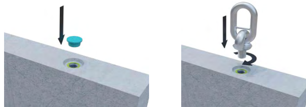
Kuva 35. Elementtiin integroitu sisäkierrenostoankkuri, jonka kierre voidaan suojata asentamisen yhteydessä ja avata uudelleen irrotettaessa (Peikko, ei pvm.).
